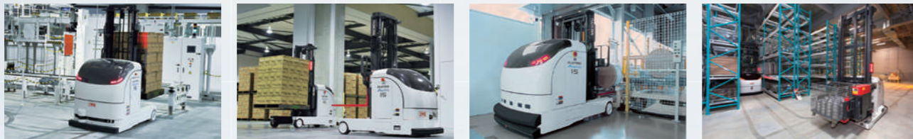
※磁気誘導をご採用の場合、床面の工事が必要となります。
